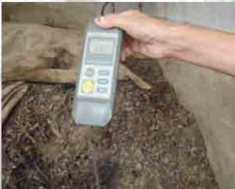
Figura 4. El control de temperatura es importante para la actividad microbiana en el compost; cuando la temperatura es alta superior a la 70° hay que bajarla con humedad. Ante ausencia de termómetro, se usa la técnica del tacto, que consiste en introducir un machete hasta el fondo por tres minutos, al tocarlo indica la temperatura alcanzada por el compost durante el proceso de descomposición y fermentación, su calidad depende de esta variable.
