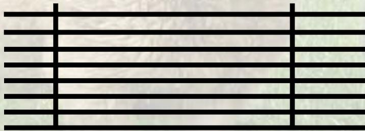
El entarimado se coloca a una altura de 70 centímetros del suelo; para sostener las tarimas, se clavan a una altura de 55 centímetros del suelo travesaños de 10 x 7.5 centímetros, estos unen los párales u horcones; sobre los travesaños se clavan costaneras de 7.5 x 5 centímetros, intercalando costaneras a cada metro y a cada 40 centímetros alternadamente.
