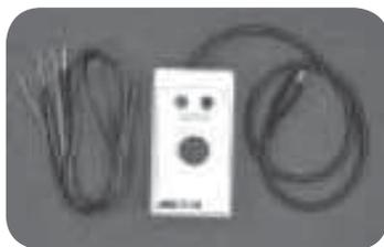
b) **VOLTÍMETRO:** Es el instrumento que permite medir el voltaje o una diferencia de potencial o fuerza electromotriz, un voltímetro se muestra en un diagrama de circuito eléctrico como un círculo con la letra V dentro del mismo. Hay voltímetros para medir una fracción de voltio y otros para medir miles de voltios.
