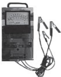
a) **AMPERÍMETRO:** El instrumento para medir la corriente eléctrica se denomina amperímetro. Un amperímetro se muestra en un diagrama de circuito eléctrico como un círculo con la letra A dentro del mismo. Hay amperímetros de distintas escalas capaces de medir una fracción de amperio y/o miles de amperios.
