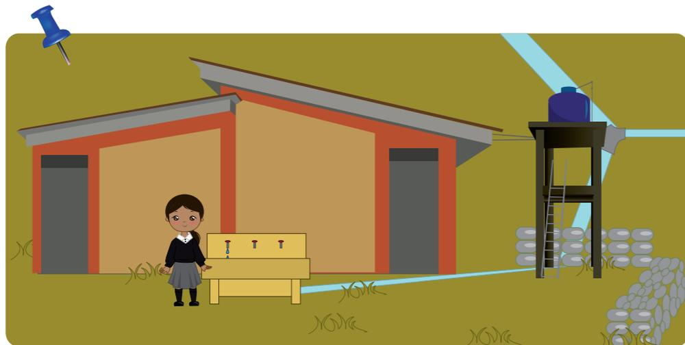
De uno de los ramales, o de la red de distribución del sistema de agua potable, se realiza la conexión hacia nuestra escuela que va hacia el tanque elevado.
