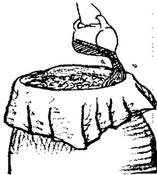
Cabe mencionar que si no se dispone de este equipo (filtro prensa), la operación se puede realizar simplemente con las telas de tocuyo, repitiendo el procedimiento varias veces.
